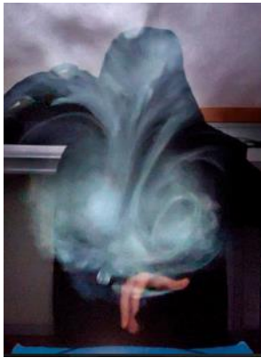
Figure 2: tourbillons formés après le passage d'un avion en papier
