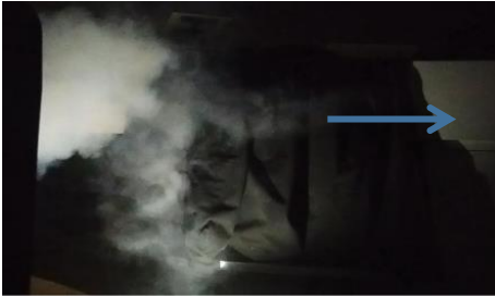
Figure 11 : tourbillons parallèles au vol de l'avion (symbolisé par la flèche bleue)
