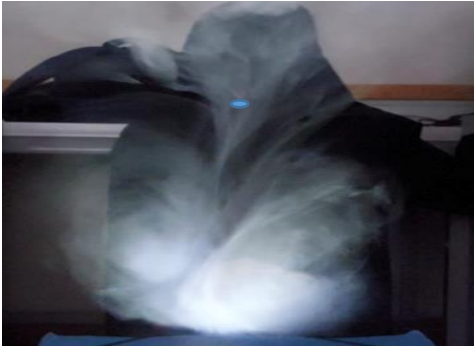
Figure 10 : des tourbillons perpendiculaires au vol de l'avion (symbolisé par l'ellipse bleue)
