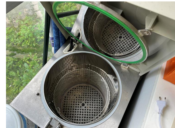
Autoclave utilisé pour désinfecter les préparations
