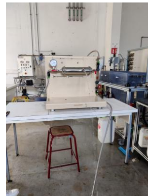
Première installation avec manomètre et rotamètre
