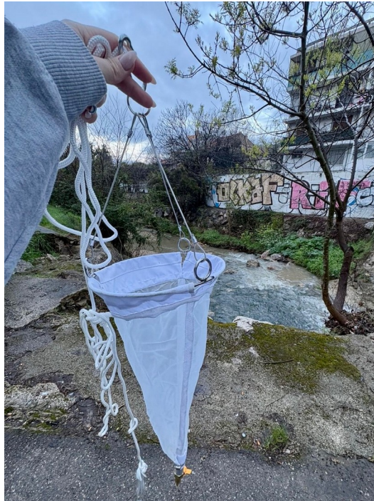
Fig. 12 — Le filet à planctons, avec le robinet de prélèvement (jaune). En arrière plan, le spot de prélèvement.
