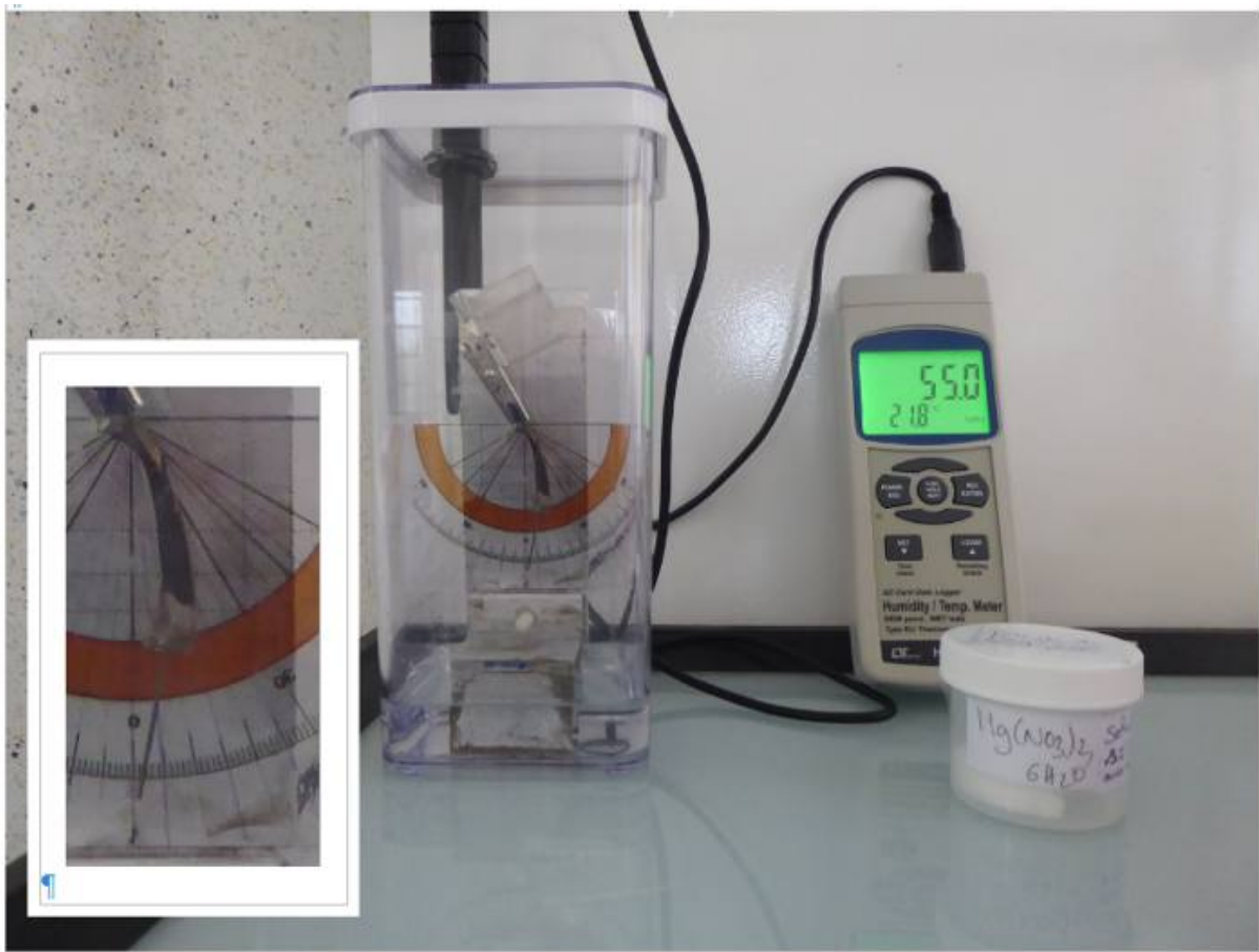
Figure 8: Photo de l'expérience permettant d'étudier l'influence de l'humidité relative sur la déformation de l'écaille.
