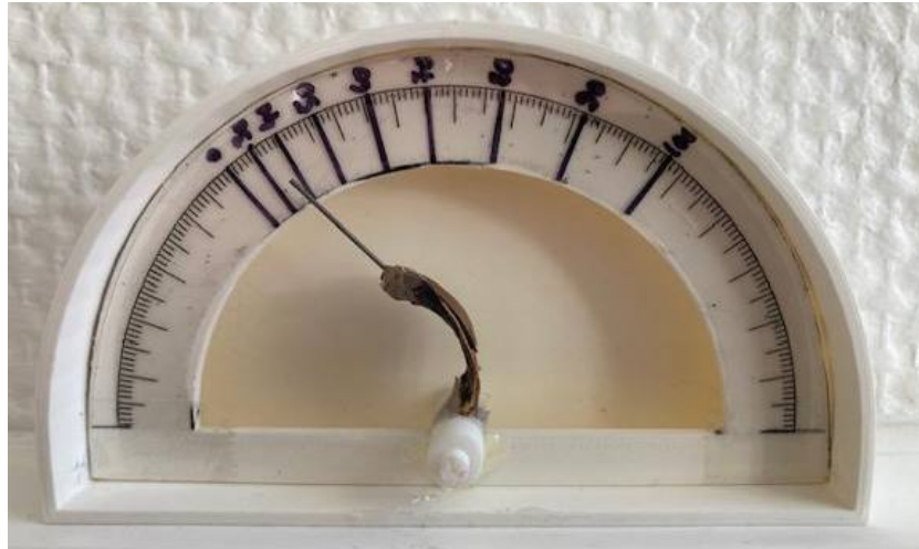
Figure 11 : Prototype d'hygromètre "low cost"
