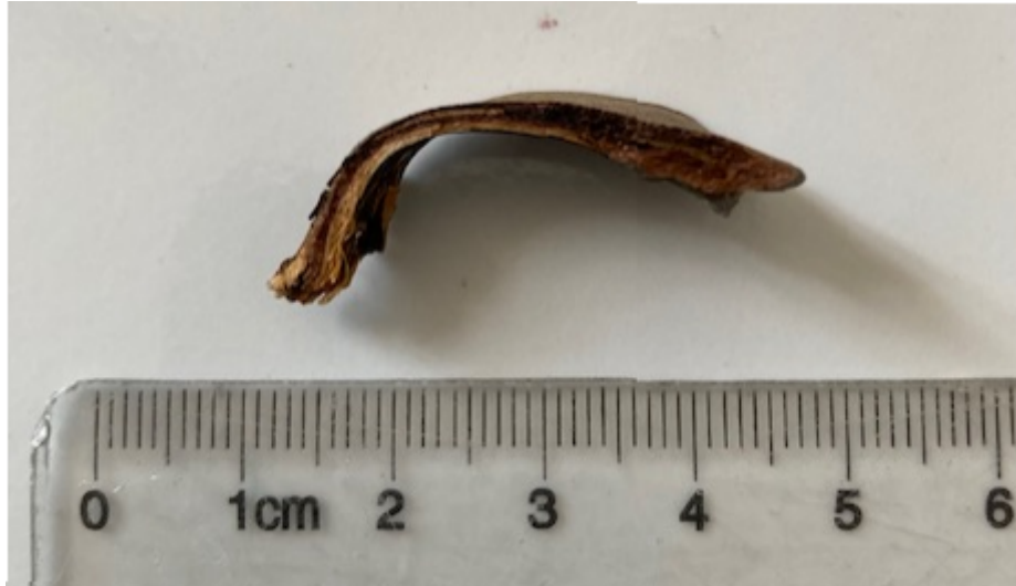
Figure 19.a. : vue en coupe de l'écaille qui montre une structure en bicouche.
