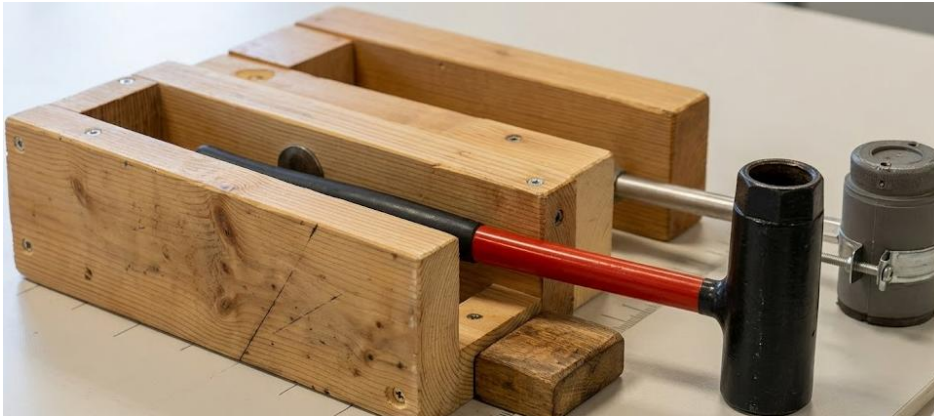
Figure 28 : 2 prototypes de marteau creux dans le but d'éliminer le rebond (ou la vibration du marteau au niveau du manche lors de l'impact)
