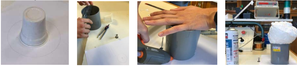
Collage du verre (rempli de béton) et du tube puis remplissage de mousse expansive
