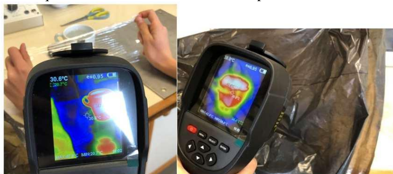
La transparence du film alimentaire et du sac poubelle dans l'infrarouge
