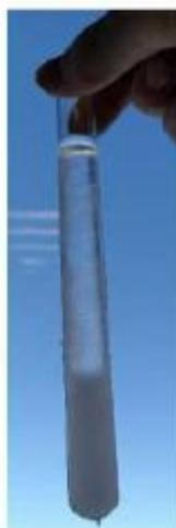
Un regard critique sur ce montage : la formation de glace dans le tube à essais, au cœur du mélange réfrigérant, est très peu visible. Cela nous met en difficulté pour interpréter la croissance de la pression de l'air lors des phases C et D observées sur le graphique... Une partie de l'eau prendrait en glace plus lentement lors des phases C et D ? Nous pourrions placer le tube à essais en périphérie du mélange réfrigérant pour une observation plus facile...
