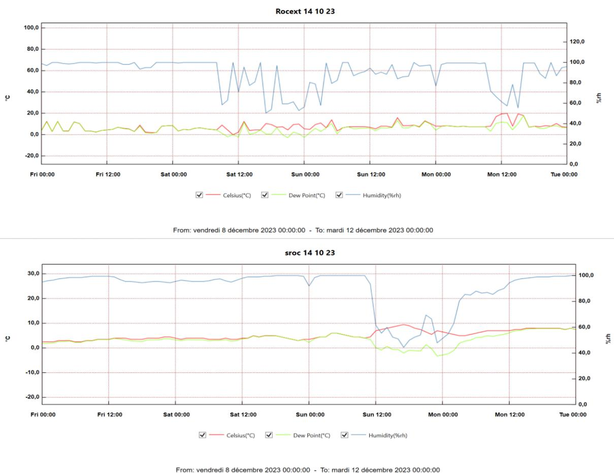
Fig.12 Haut : Traitement des données issues du capteur positionné à côté du rocher ; Bas : Traitement des données issues du capteur positionné sous le rocher. Une observation sur une semaine permet de confirmer les faibles variations de température et d'hygrométrie sous le rocher.
