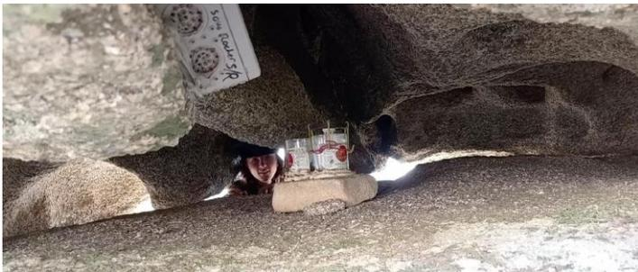
Fig.14 : « Piège à sel ». Les deux pots en verre sont placés sous le rocher afin de récolter le dépôt présents dans la cavité.
