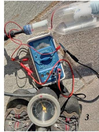
*Fig.7 : Dispositif utilisant le capteur résistif. 1 - Le capteur résistif est constitué d'une piste métallique emprisonnée dans un film plastique.*
