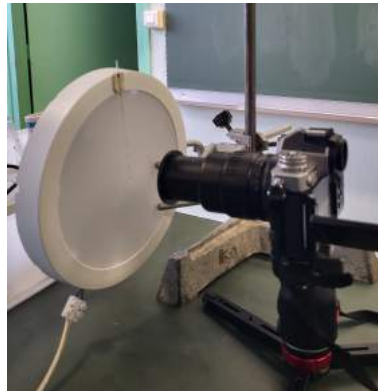
FIGURE 5 Mesures de tensions superficielles : photo du montage
