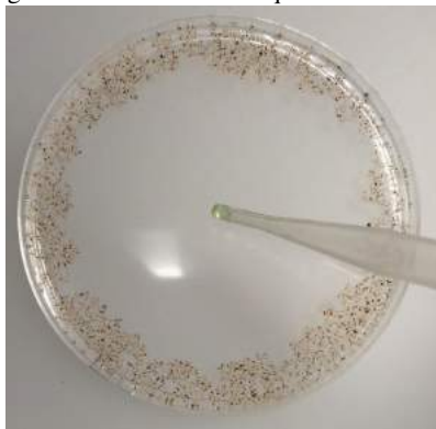
FIGURE 2 Effet Marangoni sur eau+cannelle+liquide vaisselle dans une boite Petri vide
