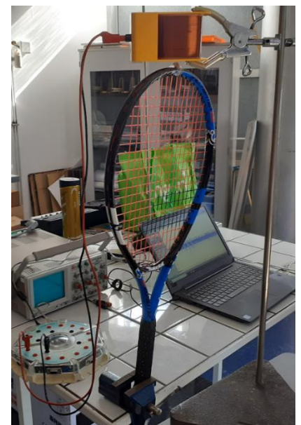
Figure 7 : dispositif expérimental avec bobine et aimant permettant de mesurer la vibration du cadre de la raquette
