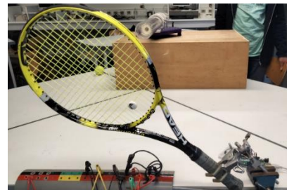
Figure 18 : capteur de force intercalé entre le manche et la pince
