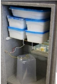
Photo 2 : mélanges « eutectique » dans l'une de nos enceintes
