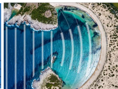
Figure 27 diffraction et interférence figure 28 diffractions schématisation de la diffraction et la réflexion des vagues sur une digue
