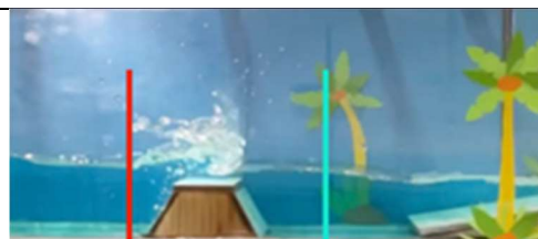
Figure 24 digue sous-marine (notre contribution)
