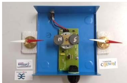
Intérieur de l'agitateur magnétique
