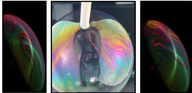
Quand on provoque le déplacement de l'eau du film en soufflant de jolies figures apparaissent. Elles sont liées aux variations d'épaisseurs.
