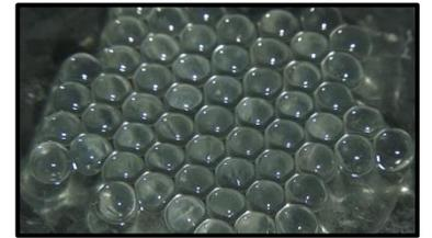
Au niveau de nos bulles, ces ponts ralentissent fortement la circulation de l'eau dans un premier temps puis quand la quantité d'eau atteint une valeur limite stoppent complètement l'écoulement. Le drainage finit par disparaître.
