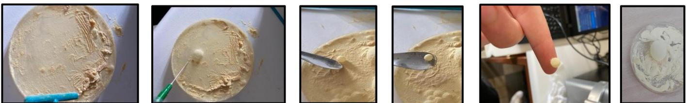
Les bulles ainsi formées peuvent être déplacées et posées sur un support. On remarque même une certaine résistance mécanique qui leur permettra de résister aux poussières et perturbations extérieures.
