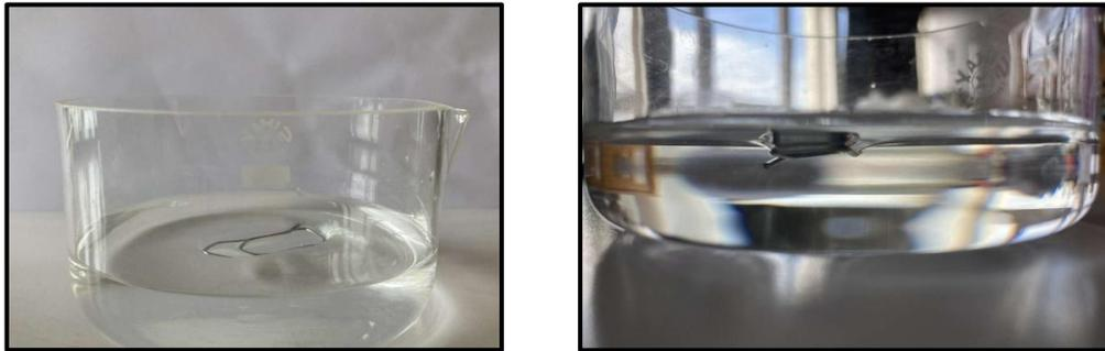
En observant la situation, on se rend compte que le trombone ne pénètre pas dans l'eau, il se pose sur la surface en la déformant mais sans la pénétrer. La situation nous fait penser à la toile d'un trampoline qui se déforme sous l'effet de notre poids. Ici c'est la surface de l'eau qui se déforme et qui retient notre trombone : les molécules présentes en surface forment une « sorte » de peau qui retient le trombone.
