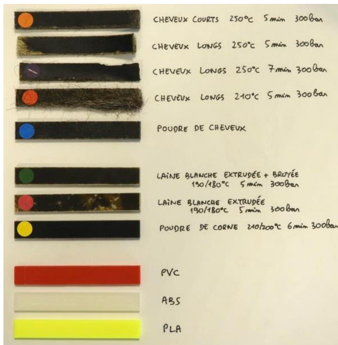
Eprouvettes des différents matériaux testés.
