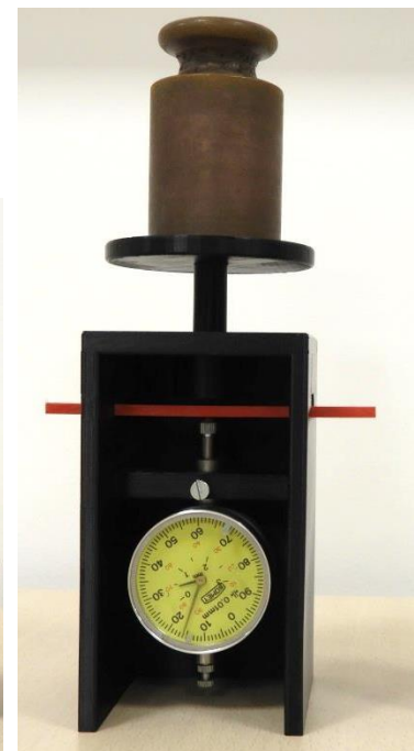
Machine de flexion 3 points obtenue après impression 3D.
