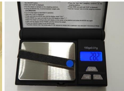
Mesure de la masse des éprouvettes.
