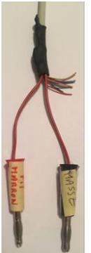
Le câble série se compose de **10 broches**, néanmoins deux seulement sont utiles pour transmettre un signal dans un sens : **la broche de transmission (fil marron)** et **la masse**. Après les avoir repérés grâce à un oscilloscope, nous avons déterminé les caractéristiques des signaux qui transitent par ces câbles grâce à une carte d'acquisition GTS2.
