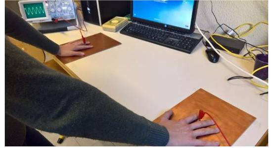
$V_e$  est obtenue avec un GBF et les amplitudes sont mesurées avec des oscilloscopes pour différentes fréquences. Les plaques sont situées à **50 cm** l'une de l'autre.
