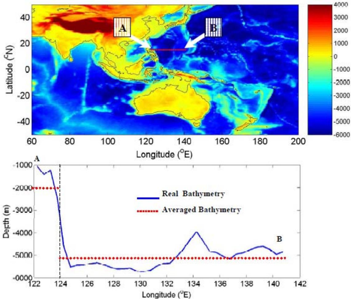
**Correction :** Avant tout, il faut déterminer la distance entre les points A et B. Cet arc de cercle est situé sur un parallèle à 15,25° de latitude nord. La circonférence de ce parallèle est égale à  $2\pi R \cos(15,25^\circ) = 38\,603,9 \text{ km}$ . La distance  $l$  entre A et B, qui vaut 18° de longitude, se décompose en une distance  $l_1$  (16° de longitude à une bathymétrie de 5000 m) et une distance  $l_2$  (2° de longitude à une bathymétrie de 2000 mètres). On a :
