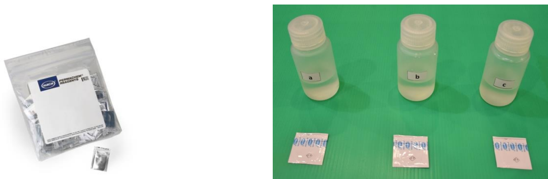
Figure 3 : Sachets contenant l'indicateur coloré (à gauche), échantillons d'eau à tester (à droite)
