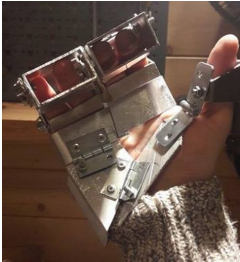
Il nous faut de plus permettre aux doigts de supporter la charge. On a donc créé un "gant" métallique.
