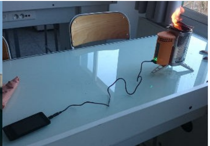
Biolite : chargeur à module Peltier
