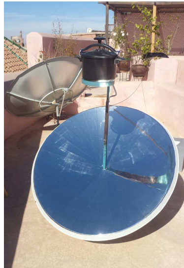
Doc. 14 : Parabole satellite recouverte de papier réfléchissant et concentrant la lumière sur la cocotte
