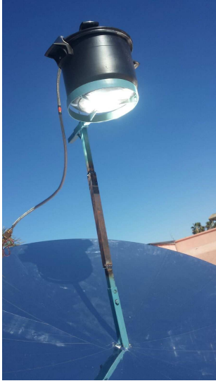
Doc. 14 : Parabole satellite recouverte de papier réfléchissant et concentrant la lumière sur la cocotte
