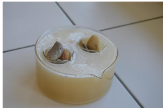
Fig 13 : solidification du gel d'agar-agar saturé en chlorure de sodium
