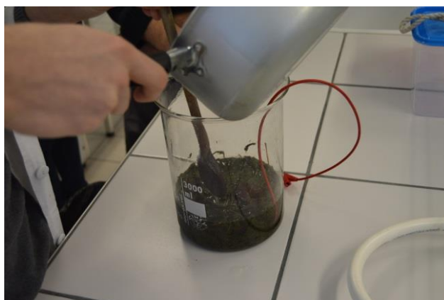
Fig 8 : coulage du pont salin
