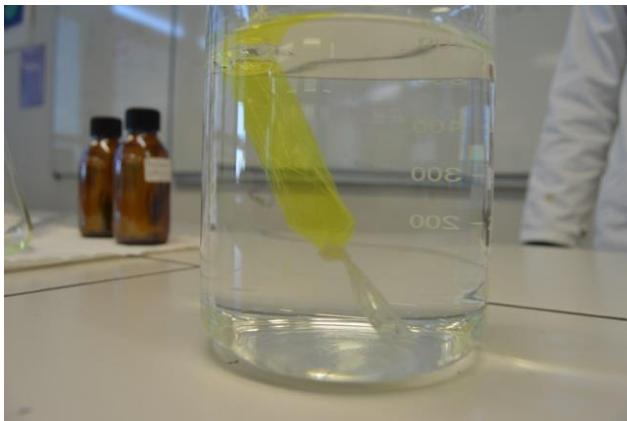
Fig 3 : boudin de dialyse contenant une solution aqueuse d'hexacyanoferrate (III) de potassium
